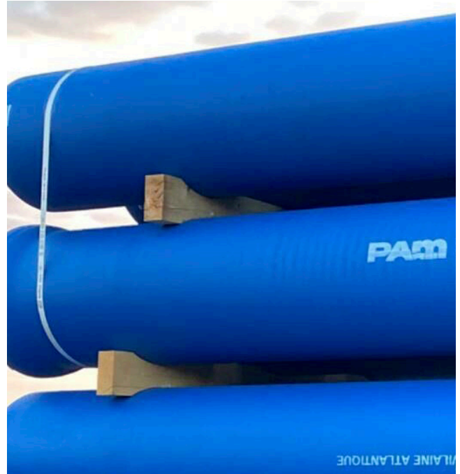
Bois de calage - transport des tuyaux
